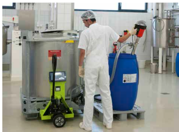
F 560 GS en operación en sector higiénico – bombeo de materia prima para una crema en una cuba de mezcla.
